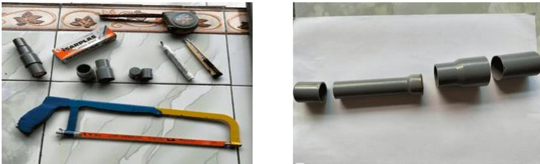
Gambar 2. Alat cetak briket secara sederhana yang didapatkan dari limbah rumah tangga berupa paralon air bekas
