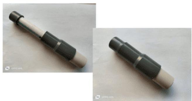
Gambar 19. Hasil alat cetak briket
