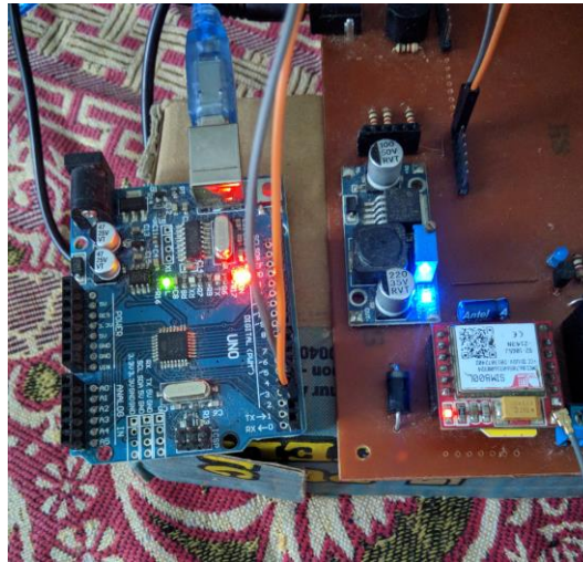
Gambar 7. menguji Modul SIM800L
