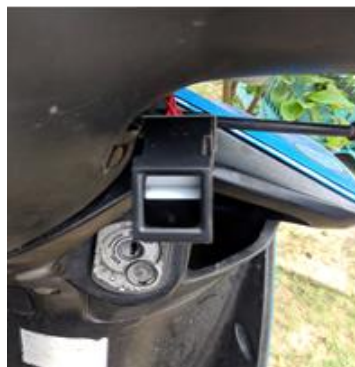
Gambar 6. Penempatan Modul Fingerprint
