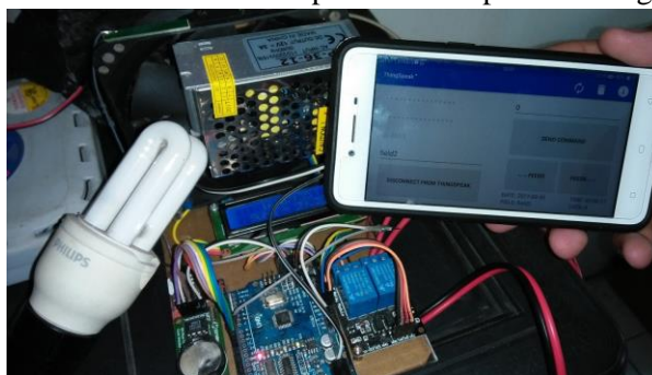
Gambar 11. Hasil Pengujian Mematikan Lampu Melalui Aplikasi ThingSpeak
