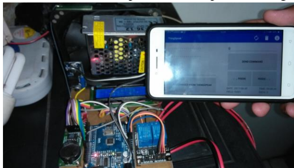
Gambar 7. Hasil Pengujian Mematikan Kipas Melalui Aplikasi ThingSpeak
