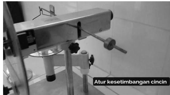
Gambar 4. Potongan Gambar Video Tutorial Penggunaan Tensiometer Dunoy Bagian Langkah-Langkah Penggunaan Alat
