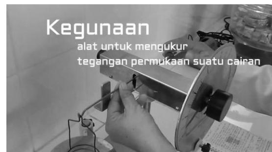
Gambar 2. Potongan Gambar Video Tutorial Penggunaan Tensiometer Dunoy Bagian Kegunaan Alat
